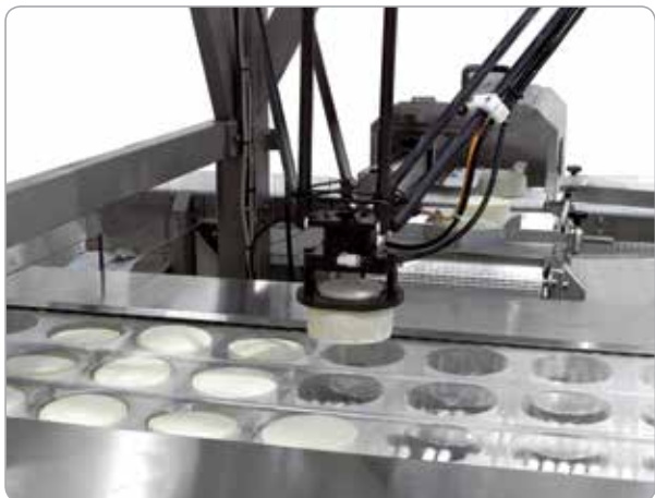
Automatización de carga de queso entero.
